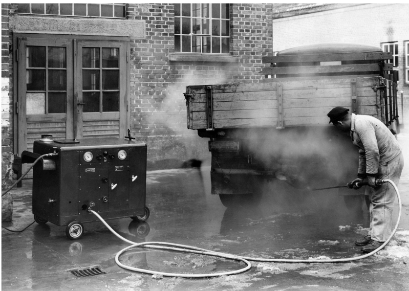
Das erste Reinigungsgerät von Kärcher: der erste europäische Heißwasser-Hochdruckreiniger KW 350 aus dem Jahr 1950.
