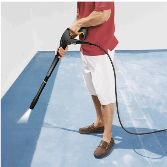
*Wer bei der Poolreinigung den Hochdruckreiniger einsetzt, wählt einen breit aufgefächerten Strahl, reduziert den Wasserdruck und hält etwas Abstand zur Oberfläche.*
